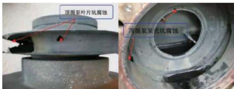
图2 150万吨/年B常压顶循泵P-107/A、B叶片腐蚀情况
